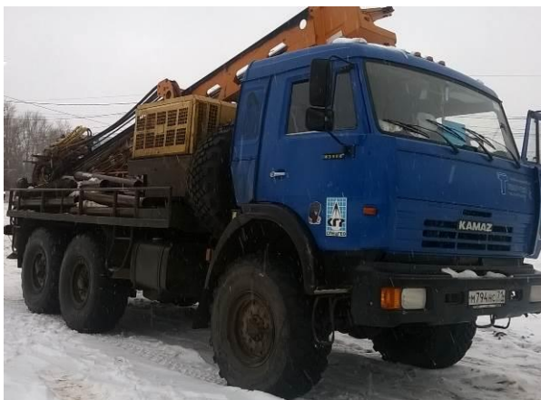
Рисунок 2 – Самоходная буровая установка УРБ-2М на базе автомобиля «КАМАЗ»
